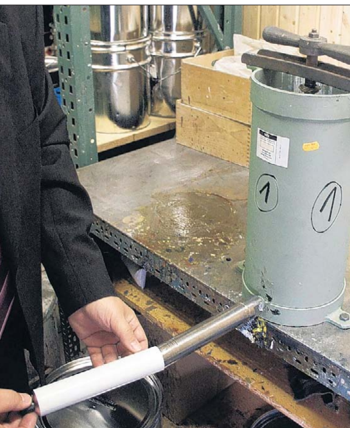
6. Das Abfüllen: Die Farbe wird von der Eisenpresse in die Tube gefüllt, die dann verschlossen und mit einer Etikette versehen wird
